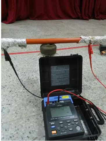
圖 3. 絕緣操作棒絕緣電阻試驗
