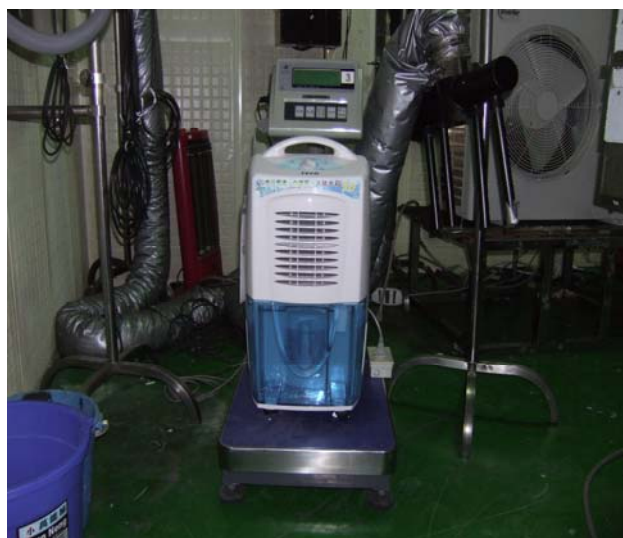
圖 4 除濕機性能實測狀態
